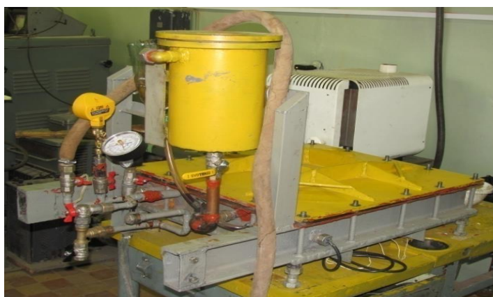
Рис.1. Принципиальная схема лабораторной вакуумной камеры для пропитки многослойных кремнеземных тканей
