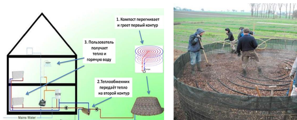
Рис. 2 Принцип работы и внешний вид биореактора
