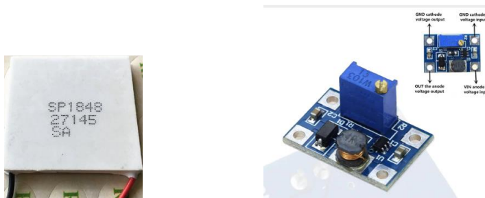
Рисунок 3. мод.Зеебека и преобразователь DC-DC SX1308 с5В до14В
